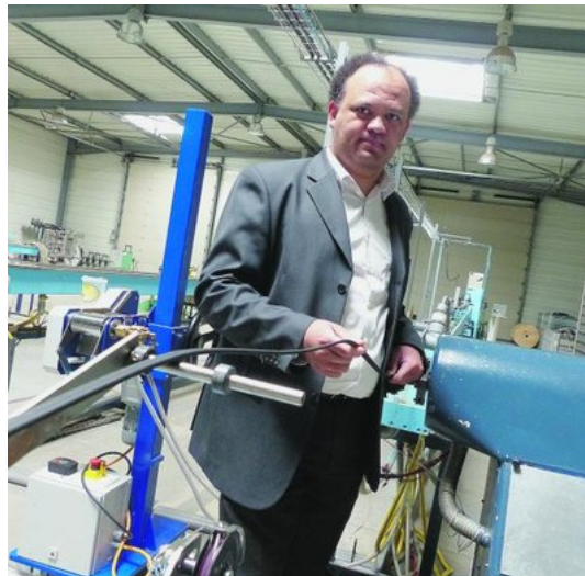
Les mélanges polymères sont élaborés à chaud sur une extrudeuse à double vis
